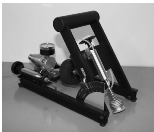
図7 VIT 摩擦測定器
