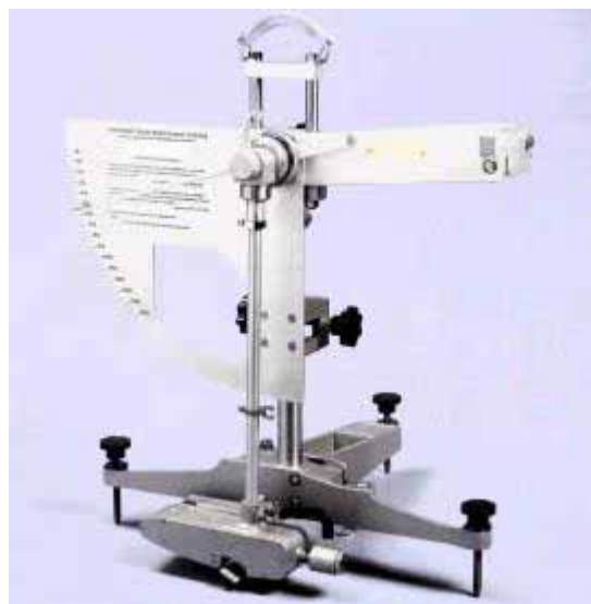
図8 EN振り子式すべり抵抗測定器
